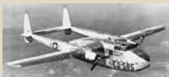
Fairchild C-82 Packet var byggt för att ta skrymmande last. Det var med detta flygplan som de schaktmaskiner flögs in som möjliggjorde byggandet av flygplatsen Tegel.
