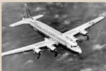
Douglas C-54 Skymaster var en militär utveckling av passagerarflygplanet DC-4. När typen sattes in på Berlintraden innebar det en kraftig ökning av tillgänglig lastkapacitet.
