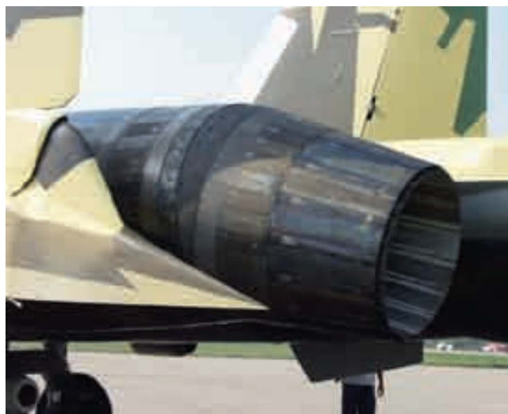
Motorernas utblåsmunstycken kan vridas. Det ger Su-35 extremt goda manöveregenskaper trots avsaknaden av canarder.
