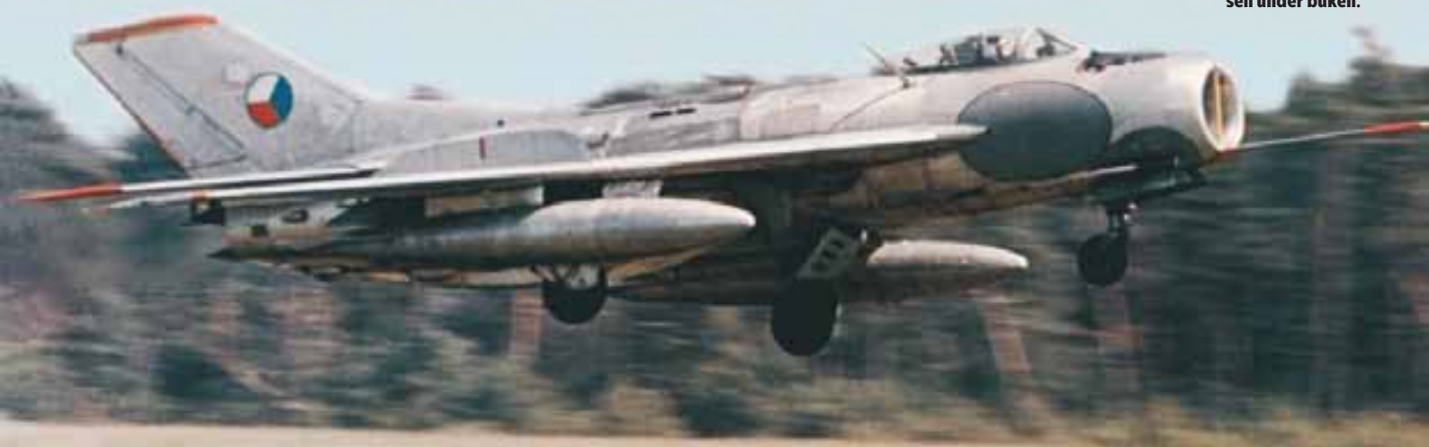
En MiG-19SF, "Farmer C", ur Tjeckoslovakiens flygvapen landar. Lagg märke till den utfällda luftbromsen under buken.
