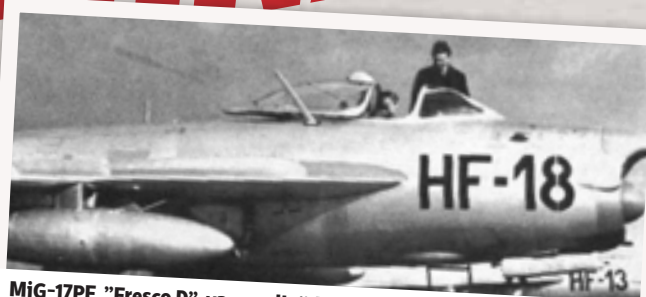
MiG-17PF, "Fresco D", var en allvädersversion med radar strax ovanför luftintaget. Motorn var en Klimov VK-1F med efterbrännkammare. Notera fälttankarna och "backspgeln" på den skjutbara huven.
