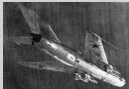
En av få bilder som visar en sovjetisk MiG-19PM, "Farmer E". Under vingarna hänger fyra jaktrobotar av typen Kaliningrad K-5M, "AA-1 Alkali" enligt Natos terminologi.
