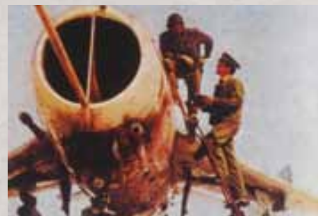
MiG-19S, "Farmer C", kom i tjänst 1956. Kanonernas placering framgår tydligt av bilden. Balkarna för raketer och bomber skymtar strax utanför respektive bakom landställsschakten.
