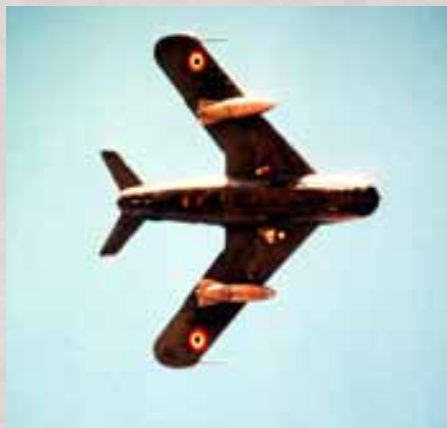
Egyptens flygvapen rustades till stor del upp med sovjetiskt materiel. Här en MiG-17F, "Fresco C", den första versionen som fick VK-1F-motorn med efterbrännkammare.
